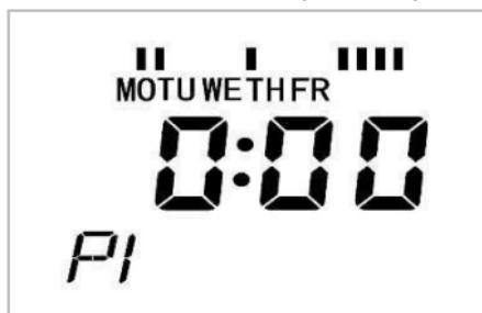
Appuyer sur BOOST/OK pour confirmer. Sélectionner le mode de température avec le bouton de réglage.
