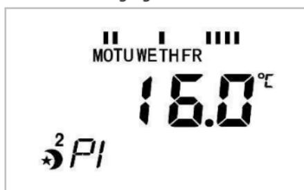
Appuyer sur BOOST/OK pour confirmer. Sélectionner le temps du point de commutation avec le bouton de réglage. Appuyer sur BOOST/OK pour confirmer et pour passer au deuxième point de commutation (P2).
