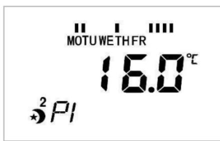
Pulse BOOST/OK para confirmar. Ahora, seleccione la hora del punto de conmutación con la rueda de ajuste. Pulse BOOST/OK para confirmar y entrar en el segundo punto de conmutación (P2).
