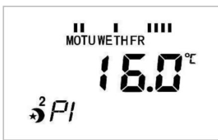
Druk op BOOST/OK om te bevestigen. Selecteer de tijd van het schakelpunt met de instelknop. Druk op BOOST/OK om te bevestigen en om naar het tweede schakelpunt (P2) te gaan.
