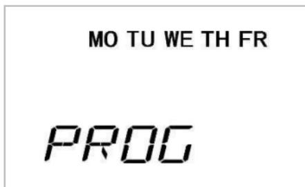
Pressione BOOST/OK para entrar no modo de programação de grupo. O termostato apresenta o primeiro ponto de comutação (P1). Tenha em conta que o tempo deste ponto de comutação não pode ser alterado.
