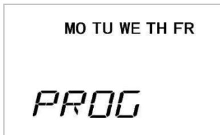
Drücken Sie BOOST/OK, um in den Block-Programmiermodus zu wechseln. Der Thermostat zeigt den ersten Schaltpunkt (P1) an. Beachten Sie, dass Sie die Uhrzeit dieses Schaltpunktes nicht ändern können.
