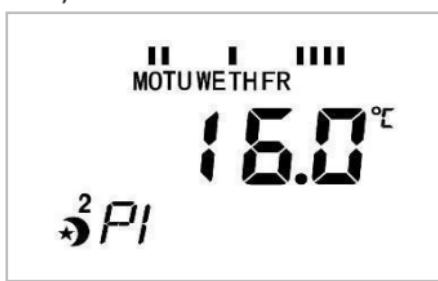
Nacisnąć BOOST/OK, aby potwierdzić. Teraz przy użyciu pokrętła wybrać czas punku przełączania. Nacisnąć BOOST/OK, aby potwierdzić oraz przejść do drugiego punktu przełączania (P2).
