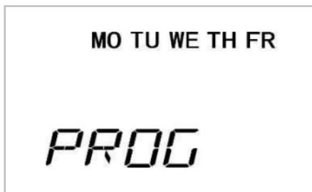
Nacisnąć BOOST/OK, aby przejść w tryb programowania grupy. Termostat wyświetla pierwszy punkt przełączania (P1). Należy pamiętać, że nie można zmodyfikować czasu tego punktu przełączania.
