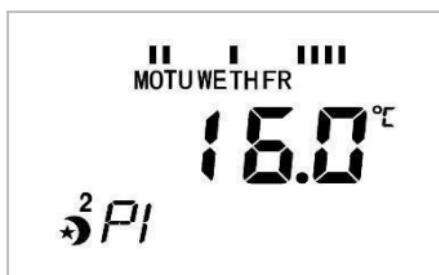
Drücken Sie BOOST/OK um zu bestätigen. Wählen Sie nun den Uhrzeit-Schaltpunkt mit dem Einstellrad. Drücken Sie BOOST/OK um zu bestätigen und in den zweiten Schaltpunkt (P2) zu wechseln.
