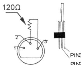
Se recomienda una terminación si el cable DMX debe cubrir una gran distancia o si se usa en un medio ambiente con mucho ruido eléctrico (ej. una discoteca). La terminación impide que el ruido eléctrico corrompa la señal de control numérico. La terminación DMX no es más que un conector XLR con una resistencia de 120Ω de polo 2 a polo 3. Este conector XLR está conectado a la salida XLR del último aparato de la serie. Véase la figura a la izquierda
