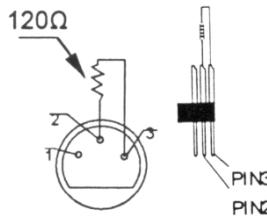
Ein DMX-Abschlusswiderstand ist empfehlenswert für Installationen, bei denen das DMX-Kabel lang ist oder in einer Umgebung mit vielem elektrischem Rauschen (z.B. Discos). Der Abschlusswiderstand verhindert Störung des digitalen Steuersignals durch elektrisches Rauschen. Der DMX-Abschlusswiderstand ist nur eine XLR-Buchse mit einem 120Ω Widerstand zwischen 2 und 3, die den XLR-Ausgang des letzten Geräts in der Kette angeschlossen wird. Siehe Abbildung links.
