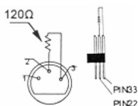
Es empfiehlt sich eine DMX-Terminierung wenn das DMX-Kabel eine große Distanz überbrücken muss oder in einer Umgebung mit vielem elektrischen Geräusch verwendet wird (z.B. Diskothek). Die Terminierung verhindert Korruption des digitalen Kontrollsignals durch elektrisches Geräusch. Die DMX-Terminierung ist nur ein XLR-Stecker mit einem Widerstand von 120Ω zwischen Pol 2 und Pol 3. Dieser XLR-Stecker wird dann in den XLR-Ausgang am letzten Gerät gesteckt. Siehe Abbildung links.
