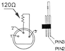
Een DMX eindweerstand is aanbevolen als de DMX-kabel vrij lang is of wordt gebruikt in een omgeving met veel elektrische ruis (bv. een discotheek). De eindweerstand voorkomt corruptie van het digitale controlesignaal door elektrische ruis. De DMX eindweerstand is niets meer dan een XLR-stekker met een weerstand van 120 Ω van pin 2 naar 3. Deze XLR-stekker wordt dan aangesloten op de XLR-uitgang van het laatste toestel in de reeks. Zie de illustraties links.
