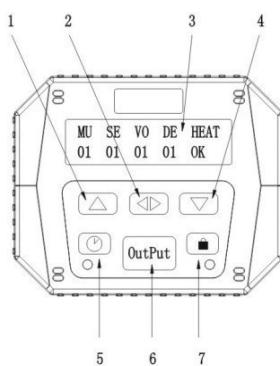
Steek de afstandsbediening achteraan in de rookmachine. Wanneer de rookmachine aan het lichtnet is verbonden en ingeschakeld, licht de hoofdschakelaar op om aan te duiden dat de rookmachine gevoed wordt. De balk onder de HEAT-aanduiding knippert. Na een opwarmtijd van ± 5 minuten zal de balk verdwijnen; OK verschijnt om aan te duiden dat de rookmachine klaar staat.
