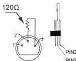
Een DMX terminator is aanbevolen als de DMX-kabel vrij lang is of wordt gebruikt in een omgeving met veel elektrische ruis (bv. een discotheek). De terminator voorkomt corruptie van het digitale controlesignaal door elektrische ruis. De DMX terminator is niets meer dan een XLR-stekker met een weerstand van 120Ω van pin 2 naar 3. Deze XLR-stekker wordt dan aangesloten op de XLR uitgang van het laatste toestel in de reeks. Zie de illustraties links.
