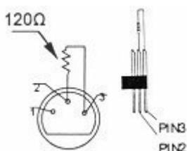
Ein DMX-Abschlusswiderstand ist empfehlenswert für Installationen, bei denen das DMX-Kabel lang ist oder in einer Umgebung mit vielem elektrischem Rauschen (z.B. Discos). Der Abschlusswiderstand verhindert Störung des digitalen Steuersignals durch elektrisches Rauschen. Der DMX-Abschlusswiderstand ist nur eine XLR-Buchse mit einem 120Ω Widerstand zwischen 2 und 3, die den XLR-Ausgang des letzten Geräts in der Kette angeschlossen wird.
