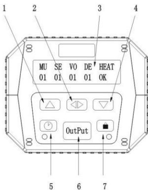
Stecken Sie die Fernbedienung hinten in die Nebelmaschine. Nachdem Sie die Nebelmaschine mit dem Netz verbunden und eingeschaltet haben, leuchtet der Hauptschalter, um anzusehen, dass die Nebelmaschine versorgt wird. Der Balken unter der HEAT-Anzeige blinkt. Nach der Aufheizzeit von  $\pm 5$  Minuten verschwindet der Balken; OK erscheint, um anzusehen, dass die Nebelmaschine gebrauchsfertig ist.
