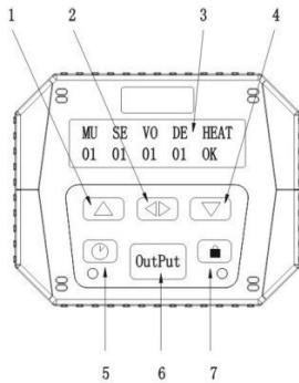
Raccorder la commande à distance à l'arrière de la machine à fumée. Une fois la machine à fumée raccordée au réseau électrique et enclenchée, l'interrupteur principal s'illumine pour indiquer que la machine est alimentée. La barre sous l'indication HEAT clignote. Après un délai d'échauffement d'environ 5 minutes, la barre disparaît et l'indication OK s'affiche. La machine à fumée est prête à l'emploi.
