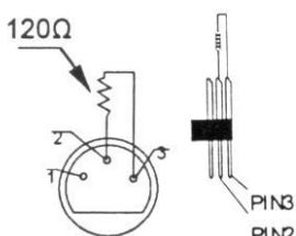
Une terminaison DMX est à recommander si le câble DMX doit couvrir une grande distance ou s'il est utilisé dans un environnement avec beaucoup de bruit électrique (p.ex. une discothèque). La terminaison prévient la corruption du signal de contrôle numérique par le bruit électrique. La terminaison DMX n'est rien d'autre qu'une fiche XLR avec une résistance de 120Ω de broche 2 vers broche 3 (voir illustration à gauche). Cette fiche XLR est connectée à la sortie XLR du dernier appareil de la série.
