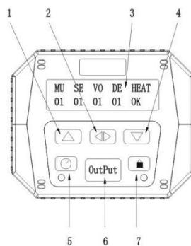
Conecte el mando a distancia a la parte trasera de la máquina de niebla. Después de haber conectado la máquina de niebla a la red y después de haberla activada, el interruptor principal se ilumina para indicar que la máquina está alimentada. La barra debajo de la indicación HEAT parpadea. Despues de un tiempo de calentamiento de aproximadamente 5 minutos, la barra desaparece y la indicación OK se visualiza. La máquina de niebla está lista para utilizar.
