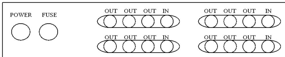
Conecte la alimentación y las señales de entrada / salida.
