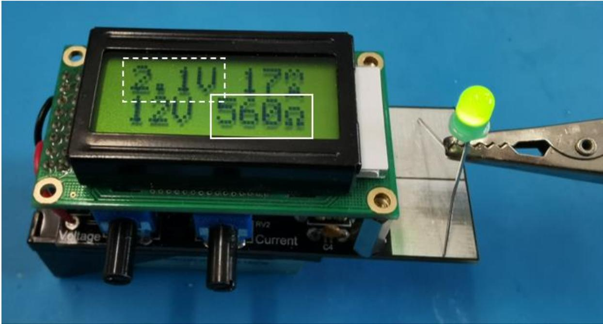
En prime, la chute de tension de la LED est mesurée et affichée.
