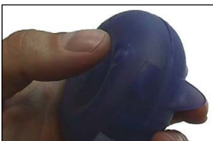
Wählschalter ein/aus/Ausdruck auf der Rückseite des Gerätes
