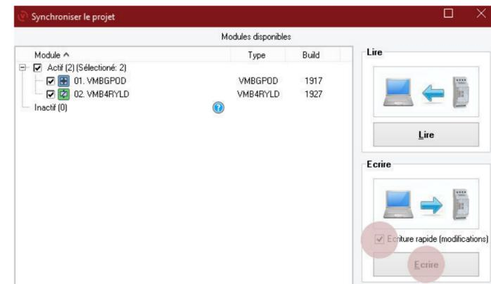
Une fois l'écriture terminée (cela ne devrait prendre que quelques secondes), vous pouvez maintenant utiliser le Relais 1 (« Lumière cuisine ») en appuyant sur le bouton supérieur gauche (Canal 1) du module de commande en finition verre.
