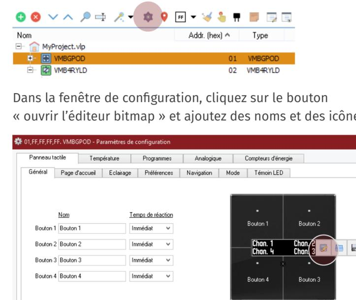
Dans la fenêtre de configuration, vous trouverez beaucoup d'autres paramètres concernant les indicateurs LED, la navigation, l'économiseur d'écran, etc. N'oubliez pas de synchroniser (sauvegarder les modifications dans les modules) avant de tester les modifications apportées.
