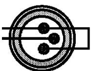
Si se debe conectar una señal de entrada no balanceada al utilizar un conector XLR, conecte los contactos 1 y 3 (véase figura a la izquierda). Para una señal de entrada no balanceada, puede también usar el conector de 6.35mm.
