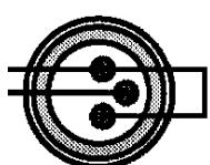
Wenn ein asymmetrisches Eingangssignal über einen XLR-Anschluss angeschlossen wird, müssen Sie eine Brücke zwischen Pin 1 und Pin 3 machen (siehe Abb. links). Für ein asymmetrisches Eingangssignal können Sie auch einen 6.35mm-Anschluss verwenden.
