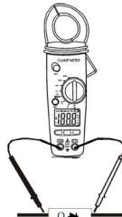
**• Medir a resistência e teste de continuidade**
